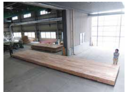
現在、国内で製造可能な最大のCLTパネル (幅3m×長さ12m、銘建工業)
