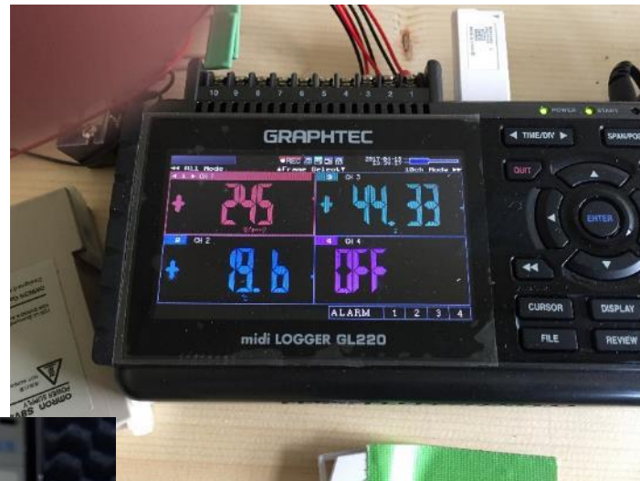
無線送信温湿度測定（センサー線付き）
