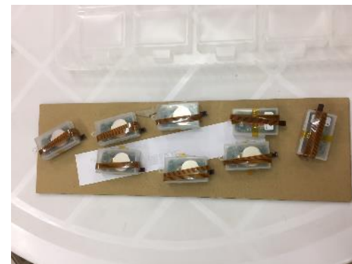
無線送信温湿度測定（センサー線付き）
