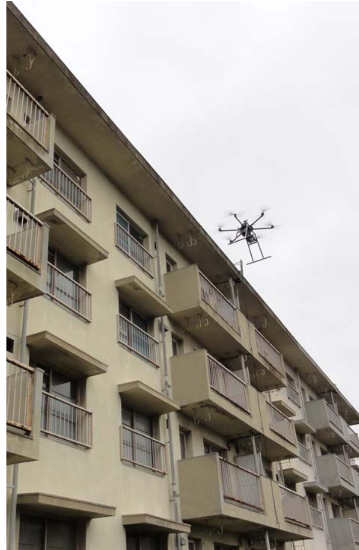
SLAM 機: 自律飛行型UAV ※3
