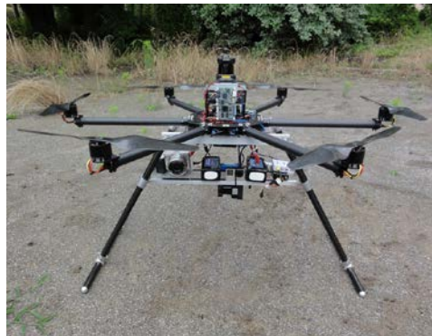
SLAM 機: 自律飛行型UAV ※3
