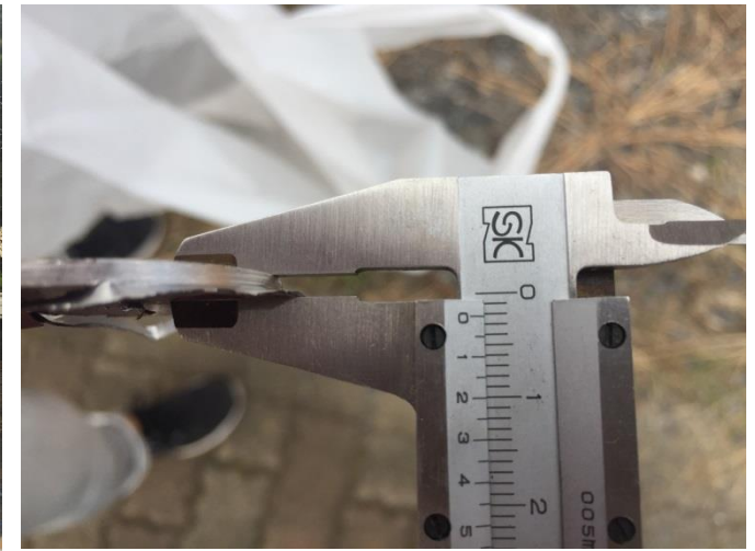
コンテナ鉄板厚は2.3mm
