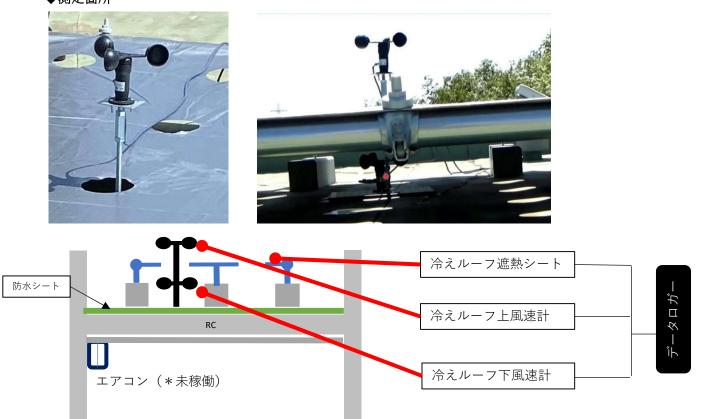
◆冷えルーフシート上と下の風速差は殆どなく、シートへの耐風圧の負圧荷重がかからないことを示している。
